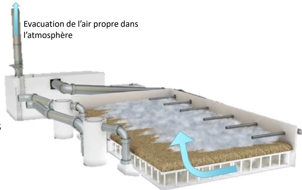
Passage de l'air dans le biofiltre
